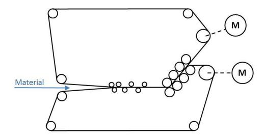
Material wird zwischen zwei Bändern durch eine Maschine transportiert. Jedes Band wird durch einen eigenen Motor angetrieben. Durch den Anpressdruck sind beide Bänder mechanisch miteinander verbunden. Wenn einer der beiden Motoren nur ein wenig schneller zu laufen versucht als der andere, ergibt sich eine ungleiche Lastverteilung.
