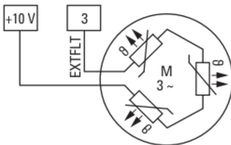
Abhängig von der Konfiguration der Eingangsklemmen steht an Klemme 3 die Funktion EXTFLT (externer Fehler) zur Verfügung. Dieser Eingang kann auch zum Anschluss eines Thermistors benutzt werden. Anschluss siehe links.
