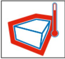
Die Temperatur am Kühlkörper des Gerätes hängt von verschiedenen umgebungsbedingten Faktoren ab, z.B. von der Umgebungstemperatur und den Kühlbedingungen. Darüber hinaus spielen der Motorstrom und auch die Taktfrequenz eine Rolle. Wird eine Temperatur nahe dem Grenzwert gemessen, reduziert der Drehzahlstarter DE1 die Taktfrequenz automatisch, so dass eine Reduzierung der Verlustleistung erfolgt. Eine Abschaltung aufgrund von Übertemperatur kann so in vielen Fällen verhindert werden.
