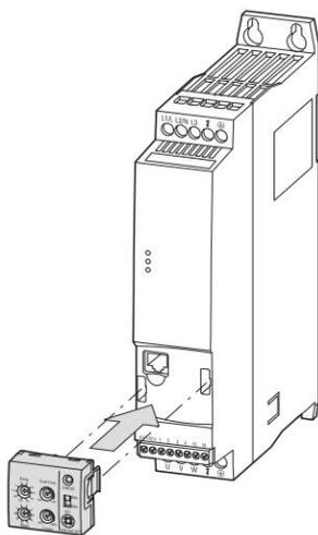
DXE-EXT-SET ist ein optional erhältliches Modul, das auf die Front des Drehzahlstarters aufgesteckt wird. Es wird verwendet, um einfache Anpassungen ausgewählter Parameter vorzunehmen, ohne dazu einen PC oder eine Tastatur zu benutzen. Das Modul ist für alle Leistungsgrößen des Drehzahlstarters gleich.
