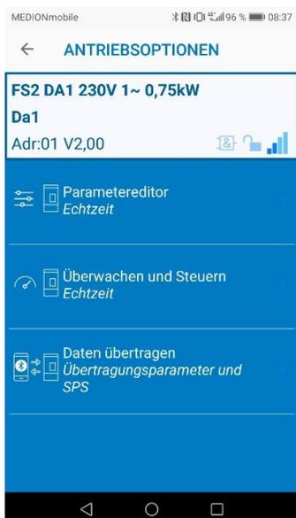
Auf dem Gerät selber, können Parameter gelesen und in Echtzeit geändert werden, aktuelle Werte überwacht und das Gerät gesteuert werden und Parametersätze oder SPS Programmdateien übertragen werden.
