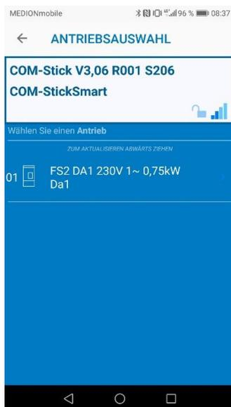
Danach kann das PowerXL Gerät ausgewählt werden, das parametrisiert oder gesteuert werden soll. Sind mehrere Geräte miteinander verbunden, können alle angeschlossenen Geräte mit einem DX-COM-STICK3 erreicht werden.
