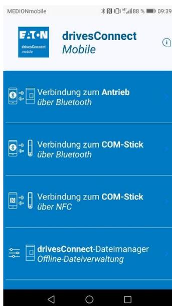
“Verbindung zum Antrieb über Bluetooth” wählen. Der DX-COM-STICK3 muss dazu in der RJ45 Schnittstelle eines PowerXL Geräts eingesteckt sein.
