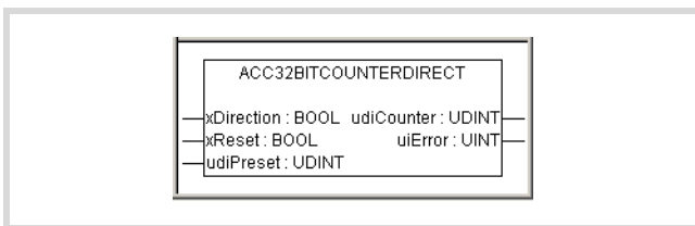
Figure 42 : Module fonctionnel pour compteur 32 bits (32 Bit Counter)
