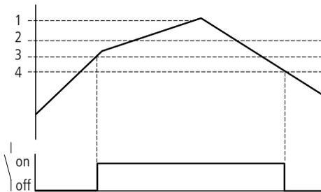
Figura 53: Diagrama de comportamiento Comparador de valores analógicos en el modo operativo "mayor que"
