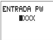
Si no se introduce ningún password, easy cambia directamente a la pantalla del password y muestra cuatro XXXX: ningún password disponible.
