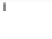
La pantalla de esquema de contactos todavía está vacía. El cursor parpadea en la parte superior izquierda; en ese punto iniciará su cableado. easy ofrece automáticamente la primera entrada de contacto **I1**.
