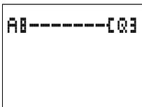
Esquema de contactos con comparador de valores analógicos.
