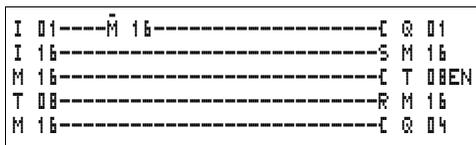
Figura 147: Reset automatico della segnalazione di guasto
