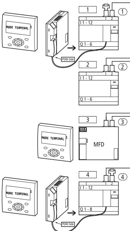
Figure 65 : Mode terminal au sein d'un réseau easy-NET et via deux interfaces série
