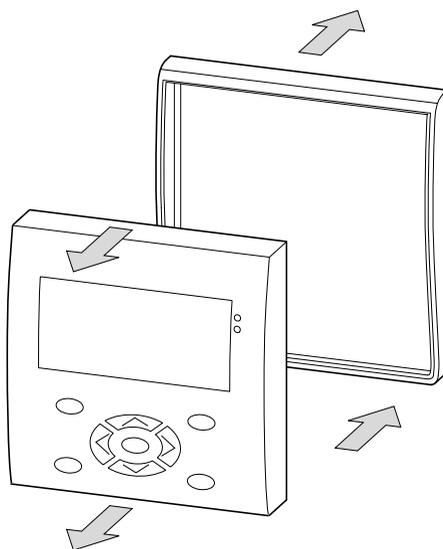
Figure 7 : Démontage du plastron
