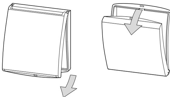
Figure 8 : Positions du capot de protection
