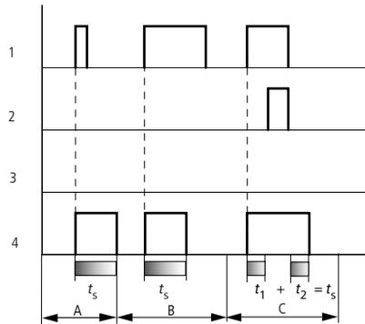
Figure 127 : Diagramme fonctionnel n° 1 d'un relais temporisé avec mise en forme d'une impulsion
