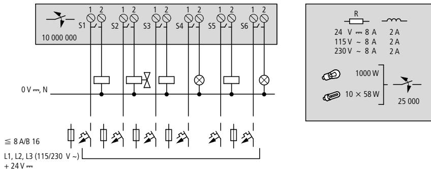
Figure 37 : Sorties à relais EASY6...-RE..
