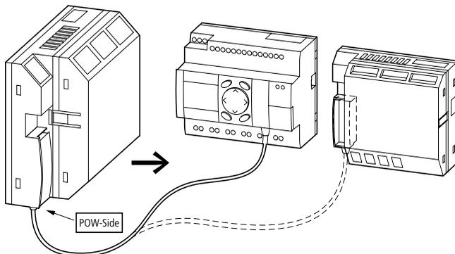
Figure 48 : Liaison point à point via l'interface série
