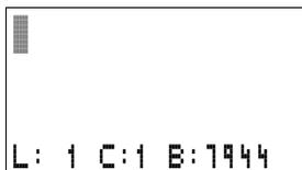
L'affichage de schéma de commande est encore vide pour le moment. Le curseur clignote dans la partie supérieure gauche; c'est à cet emplacement que débutera votre câblage.
