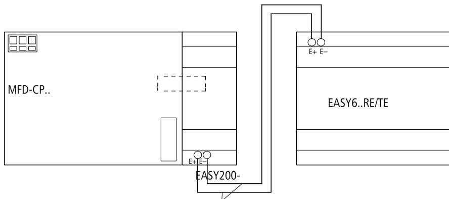
Figure 50 : Raccordement d'extensions décentralisées à MFD-Titan
