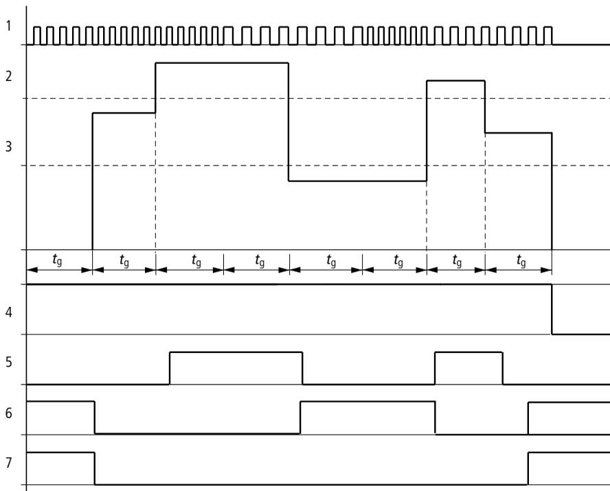
Figure 90 : Diagramme fonctionnel d'un compteur de fréquence
