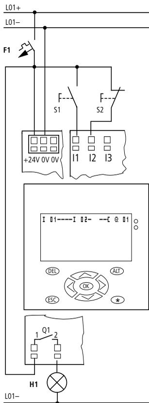
Figure 52 : Commande d'une lampe à l'aide d'un appareil MFD
