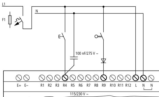
Figure 26 : Augmentation du courant d'entrée
