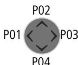
Ces quatre touches sont repérées dans le schéma de commande en tant que contacts P 01 à P 04. Ces touches P peuvent être activées et désactivées dans le Menu spécial → SYSTEME.
