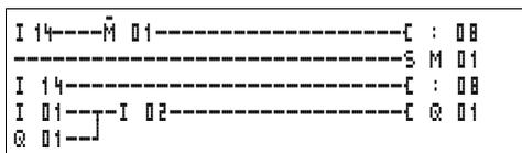
Figure 148 : Schéma de commande destiné à contrôler l'extension
