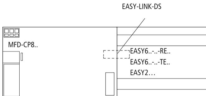
Figure 49 : Raccordement d'extensions locales à MFD-CP8..
