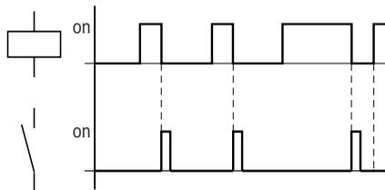
Figure 82 : Diagramme fonctionnel d'une impulsion sur un cycle en cas de front descendant
