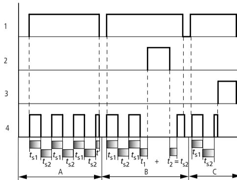
Figure 129 : Diagramme fonctionnel d'un relais temporisé de type clignoteur synchrone et asynchrone
