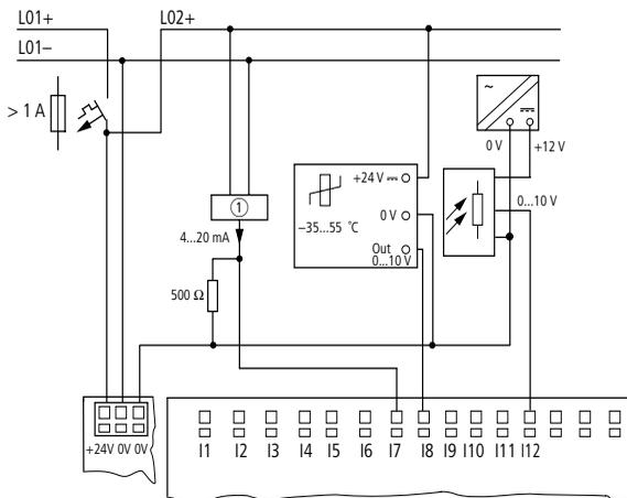
Figure 32 : Sonde de température, capteur de luminosité, capteur 20 mA
