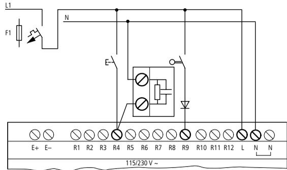
Figure 28 : easy600 équipé d'un EASY256-HCI
