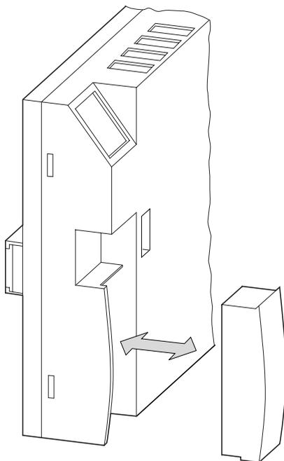
Figure 149 : Retrait et mise en place du capot
