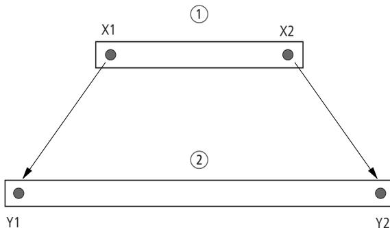
Figure 110 : Module fonctionnel de type mise à l'échelle de valeurs : augmentation de la plage de valeurs
