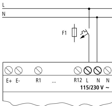
Figure 20 : Tension d'alimentation des appareils d'extension de type AC
