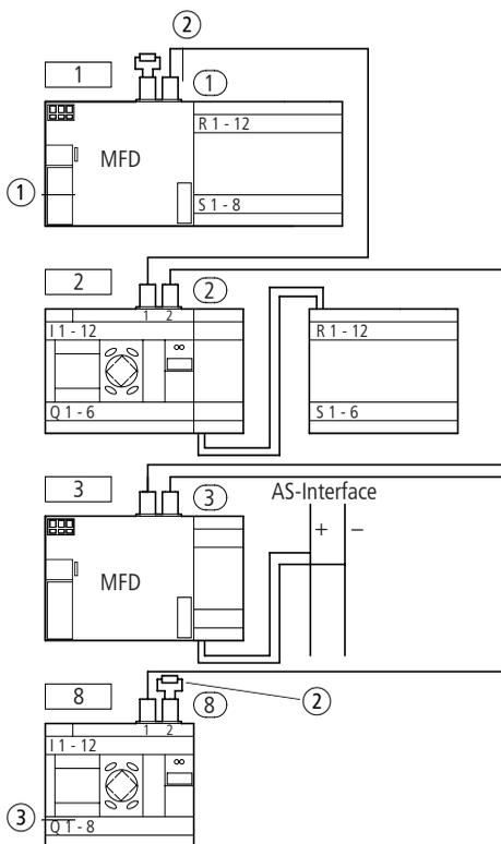
Figure 46 : Résistances de terminaison de bus
