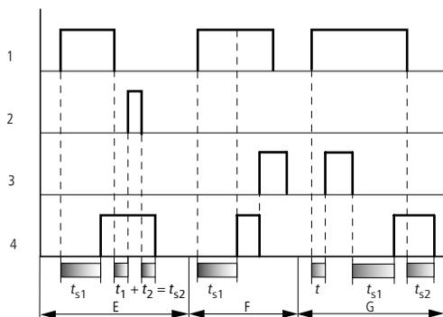
Figure 125 : Diagramme fonctionnel n° 2 d'un relais temporisé retardé à l'appel et à la chute
