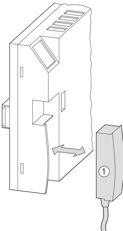
Figure 151 : Enfichage et retrait du câble EASY800-PC-CAB
