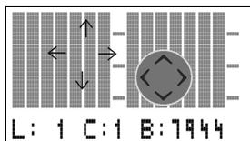
Le déplacement du curseur s'effectue à l'aide des touches de direction  $\wedge \vee < >$ , suivant la trame invisible du schéma de commande.
