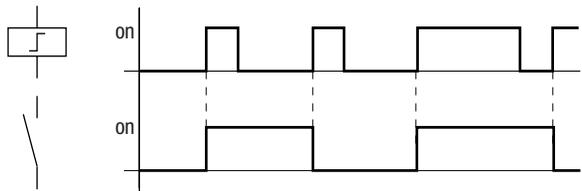
Figure 77 : Diagramme fonctionnel d'un relais avec fonction télérupteur
