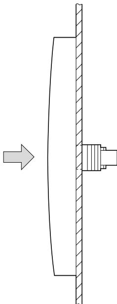
Figure 12 : Montage de l'unité d'affichage et de commande opérateur
