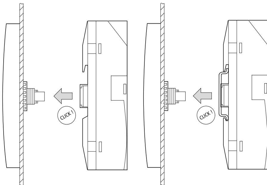
**Montage des entrées/sorties sur le module
