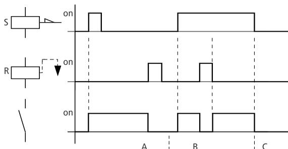
Figure 78 : Diagramme fonctionnel des fonctions « bobine d'accrochage » et « bobine de décrochage »
