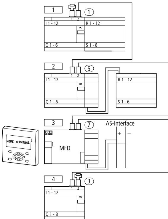
Figure 63 : Mode terminal au sein d'un réseau easy-NET
