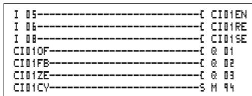
Figure 93 : Schéma de commande MFD-Titan avec compteur/codeur incrémental rapide
