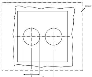
Figure 11 : Trous de perçage pour un appareil MFD
