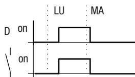
Figure 105 : Diagramme fonctionnel d'une « commutation durant la nuit »
