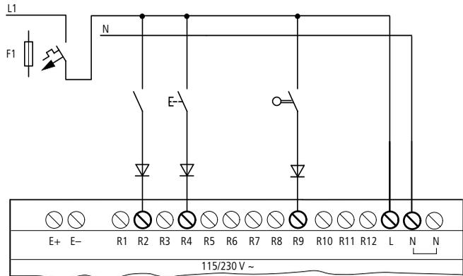
Figure 25 : easy-AC avec diode au niveau des entrées
