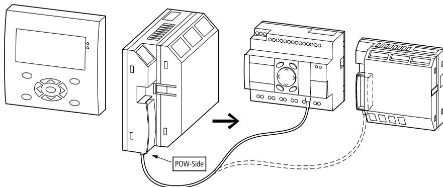
Figure 139 : Liaison COM-LINK vers un appareil easy800 ou un autre appareil MFD
