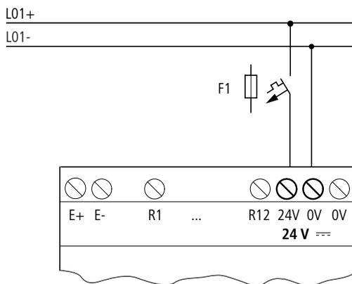
Figure 22 : Tension d'alimentation des appareils d'extension de type DC
