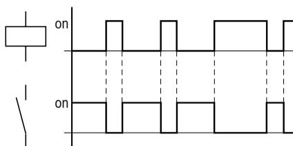
Figure 80 : Diagramme fonctionnel de la fonction contacteur inversée
