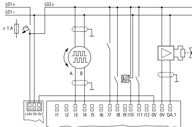
Figure 42 : Raccordement d'une servovalve
