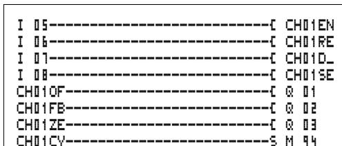
Figure 91 : Schéma de commande MFD-Titan avec compteur rapide
