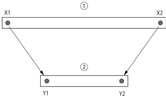
Figure 109 : Module fonctionnel de type mise à l'échelle de valeurs : réduction de la plage de valeurs
