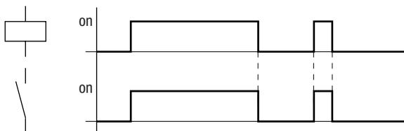
Figure 76 : Diagramme fonctionnel d'une bobine avec fonction contacteur
