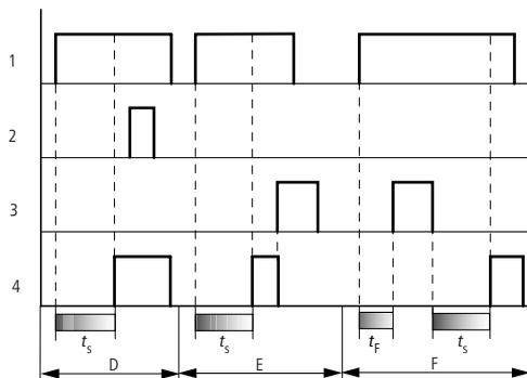
Figure 121 : Diagramme fonctionnel d'un relais temporisé retardé à l'appel (avec/sans commutation aléatoire)
