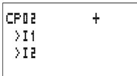
Affichage des paramètres et jeu de paramètres relatifs aux modules de type comparateur :
