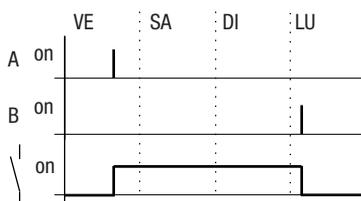
Figure 104 : Diagramme fonctionnel d'un réglage « week-end »
