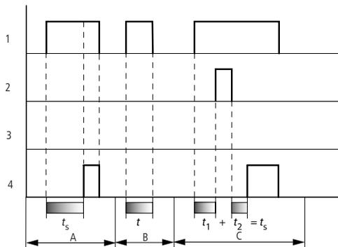
Figure 120 : Diagramme fonctionnel d'un relais temporisé retardé à l'appel
