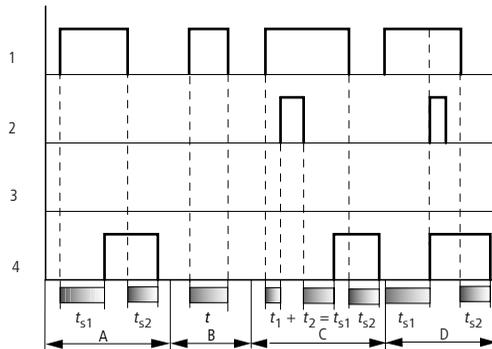
Figure 124 : Diagramme fonctionnel n° 1 d'un relais temporisé retardé à l'appel et à la chute
