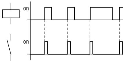
Figure 81 : Diagramme fonctionnel d'une impulsion sur un cycle en cas de front montant
