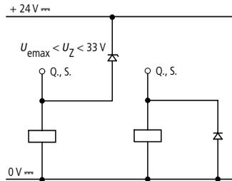
Figure 41 : Inductance avec circuit de protection
