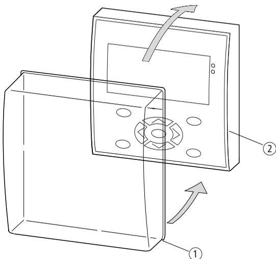
Figure 5 : Montage de la membrane de protection
