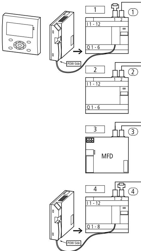
Figure 140 : Réseau easy-NET et liaisons COM-LINK
