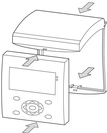
Figure 9 : Montage du capot de protection
