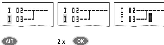
Figure 66 : Passage du contact à fermeture I 03 en contact à ouverture
