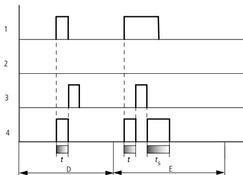
Figure 128 : Diagramme fonctionnel n° 2 d'un relais temporisé avec mise en forme d'une impulsion
