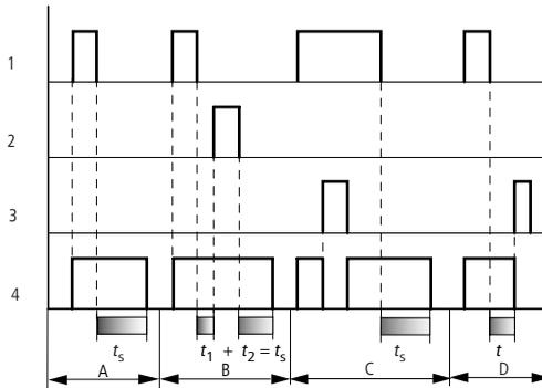
Figure 122 : Diagramme fonctionnel d'un relais temporisé retardé à l'appel
