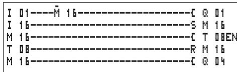
Figure 147 : Remise à zéro automatique de la signalisation de défaut
