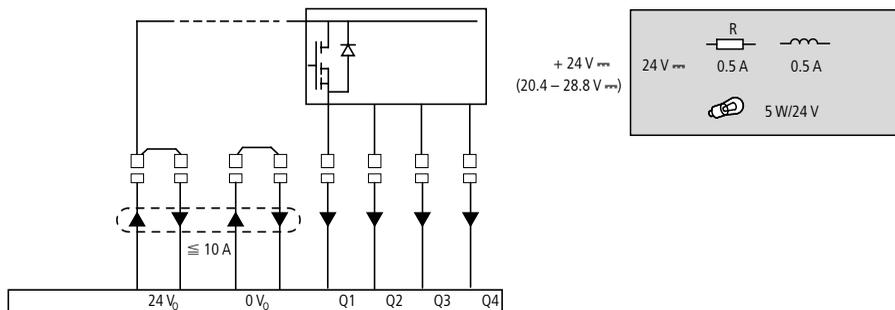
Figure 39 : Sorties à transistors MFD-T..
