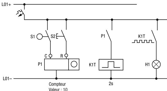
Figure 131 : Câblage fixe avec relais
