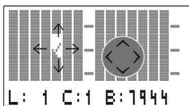
Le « stylo graphique » permet de raccorder des contacts et des relais. Il reprend la forme d'un curseur dès qu'on le déplace sur un contact ou une bobine de relais.
