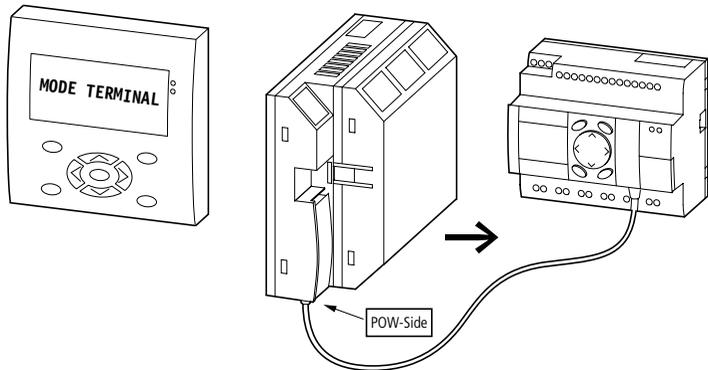
Figure 62 : Mode terminal avec topologie de type « liaison point à point »
