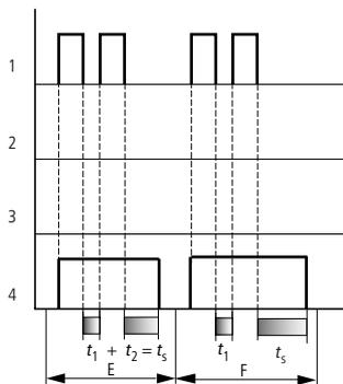
Figure 123 : Diagramme fonctionnel d'un relais temporisé retardé à l'appel
