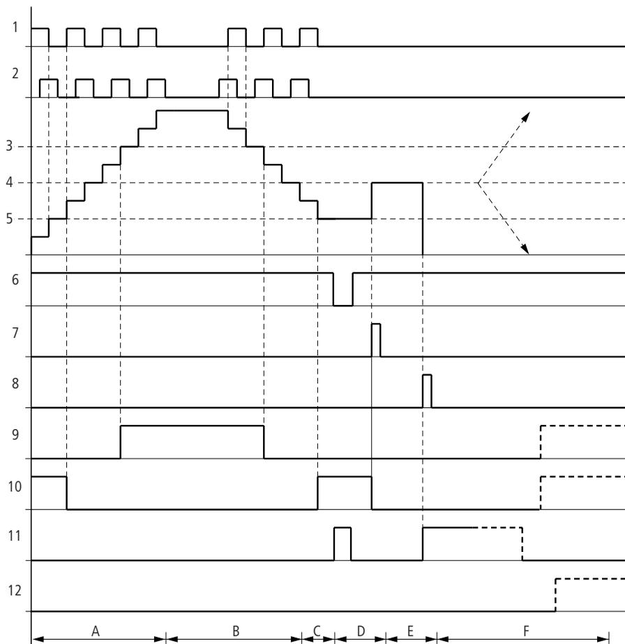
Figure 94 : Diagramme fonctionnel d'un compteur/codeur incrémental rapide
