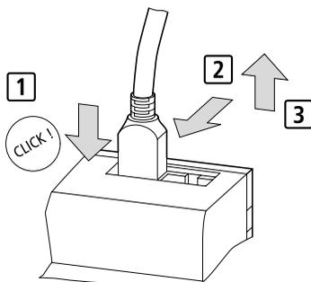
Figure 47 : Insertion et retrait d'un câble
