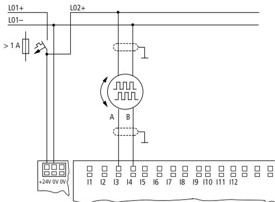
Figure 34 : Raccordement d'un codeur incrémental
