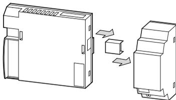
Figure 19 : Raccordement des extensions
