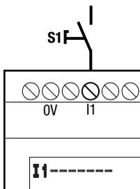
Figure 142 : Entrée de l'appareil MFD occupée par un interrupteur
