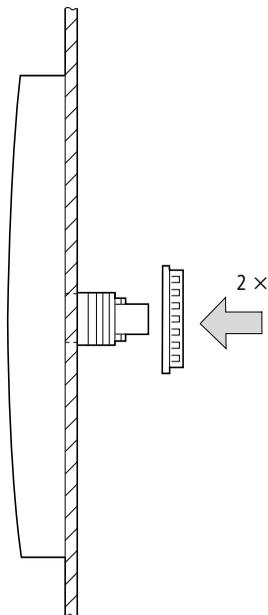
Figure 13 : Vissage de l'unité d'affichage et de commande
