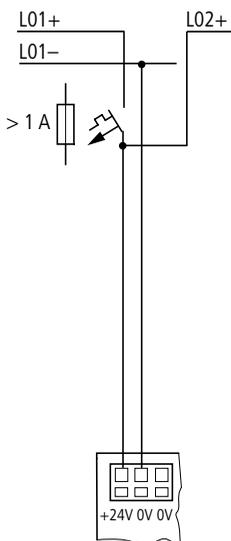
Figure 21 : Alimentation en tension d'un appareil MFD
