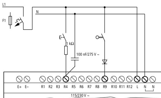
Figure 27 : Limitation du courant d'entrée au moyen d'une résistance
