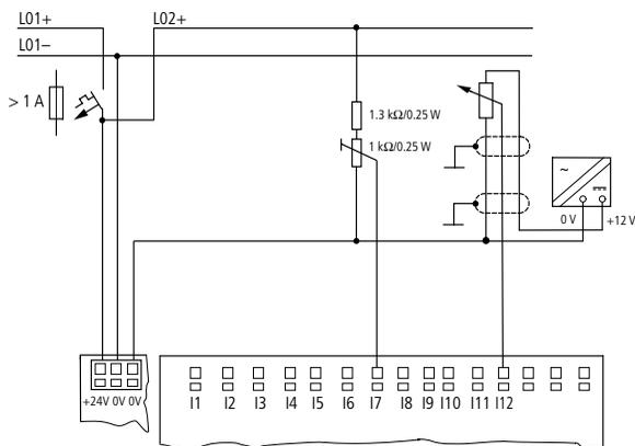
Figure 31 : Potentiomètre d'entrée de consignes avec résistance amont
