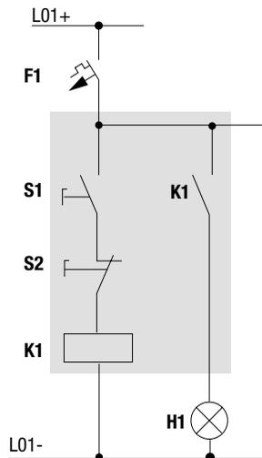
Figure 51 : Commande d'une lampe à l'aide d'un relais
