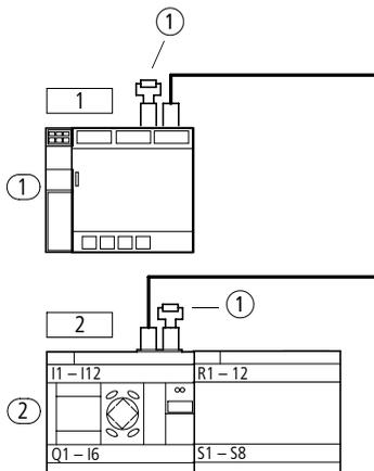
Figure 60 : Exemple de topologie avec deux participants easy-NET
