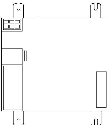
Figure 16 : Fixation par vis d'un appareil MFD
