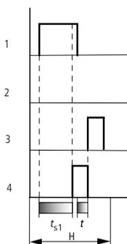
Figure 126 : Diagramme fonctionnel n° 3 d'un relais temporisé retardé à l'appel et à la chute
