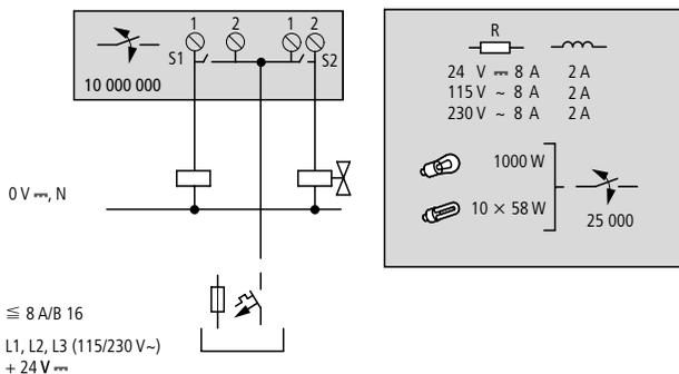
Figure 38 : Sorties à relais EASY2...-RE..
