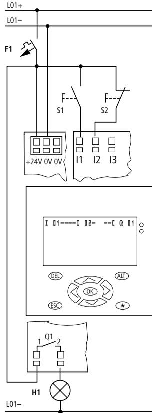
Figure 132 : Câblage à l'aide d'un appareil MFD-Titan
