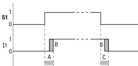
Figure 144 : Comportement en cas de désactivation de la fonction « temporisation d'entrée »
