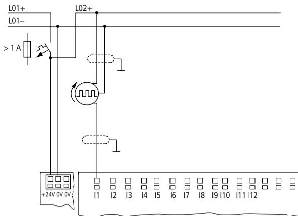
Figure 33 : Compteur rapide, générateur de fréquence
