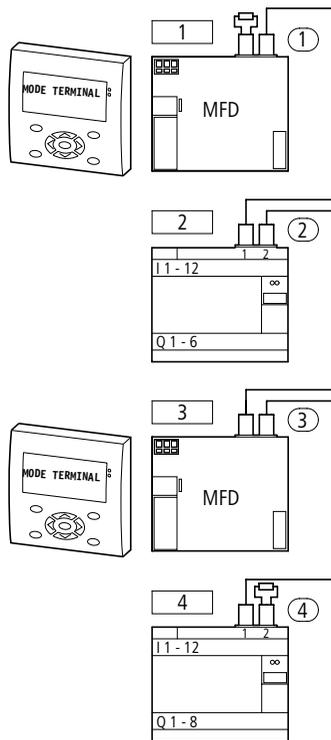
Figure 64 : Exploitation en tant que terminal au sein d'un réseau easy-NET, avec deux appareils MFD
