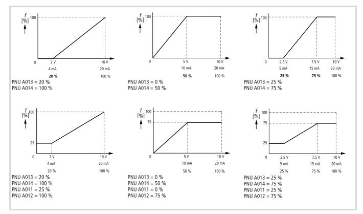
Figure 141: Analog actual value signal matching
