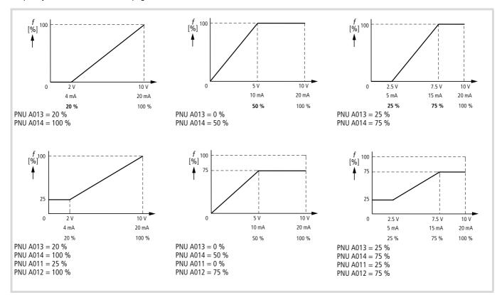
Figure 123: Matching the analog actual value signal
