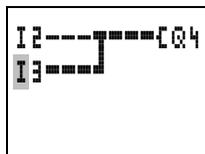
Vous pouvez suivre une liaison conductrice de courant sur les branches de circuit en faisant défiler les lignes de l’afficheur vers le haut et vers le bas.
