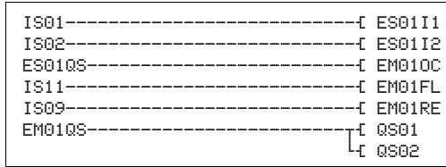
Figura 176: Esempio "Ritorno": schema elettrico in easySafety
