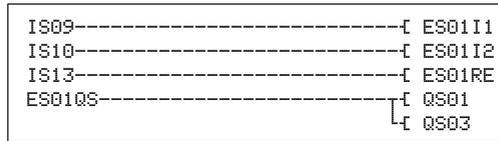
Figure 189 : Exemple « arrêt d'urgence » : schéma en easySafety
