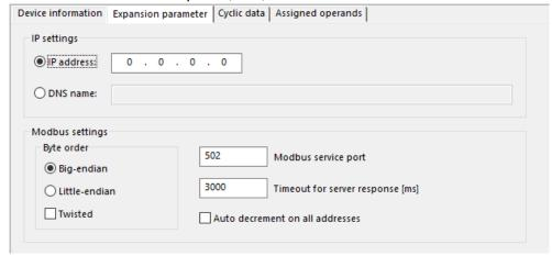
Fig. 354: Expansion parameter tab for Modbus TCP servers
