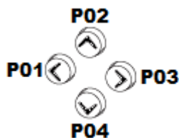
Obr. 112: Kurzorová tlačítka jsou propojena ve spínacím schématu jako kontakty P 01 až P 04.
