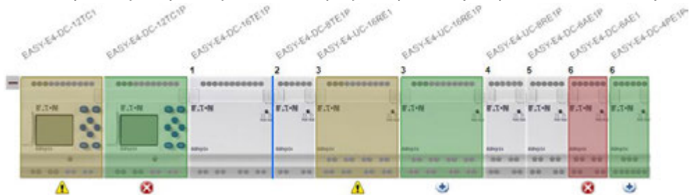
Obr. 312: Náhled projektu ONLINE s různě zbarvenými přístroji podle kompatibility
