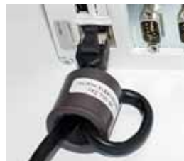
Abb. 43 Ethernet-Leitung, Schlaufe 2-fach durch Ferrit
