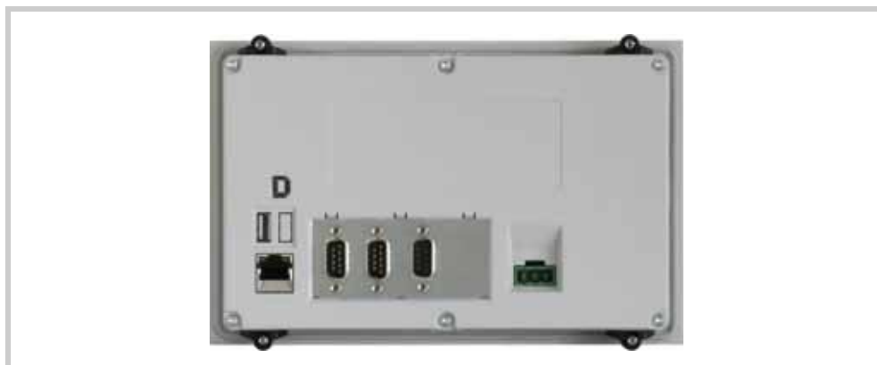
Abb. 36 7,0"-Geräte mit vier Halteklammern (erfüllt IP65 / NEMA 4X nicht)
