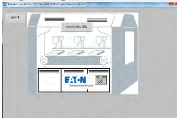
Abbildung 84: Touch-Panel-Ansicht der Maske Maschinensteuerung im Zustand ON
