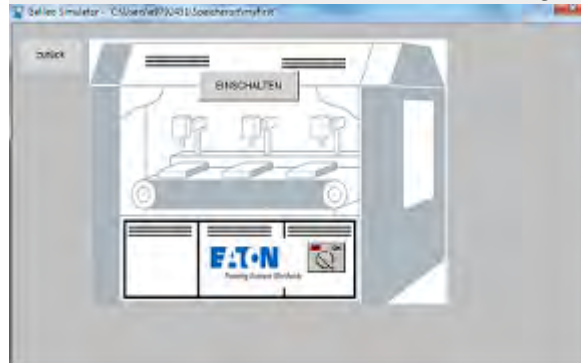
Abbildung 83: Touch-Panel-Ansicht der Maske Maschinensteuerung im Zustand OFF
