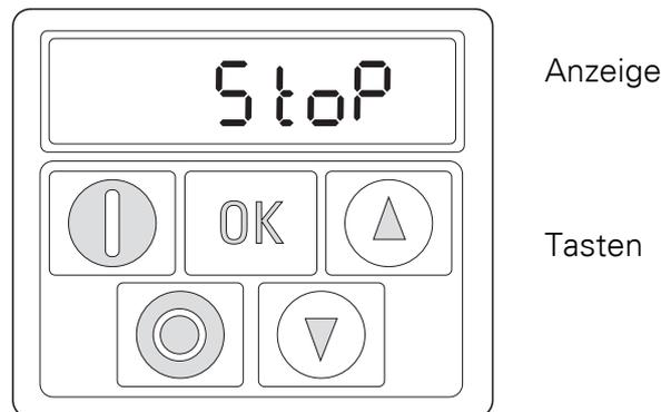
Abbildung 1: Ansicht der Bedieneinheit
