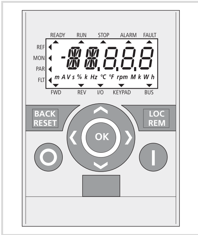
Figure 63 : Affichage de la console de paramétrage avec afficheur LCD, touches de fonction et interface LCD = Liquid Crystal Display (afficheur à cristaux liquides)
