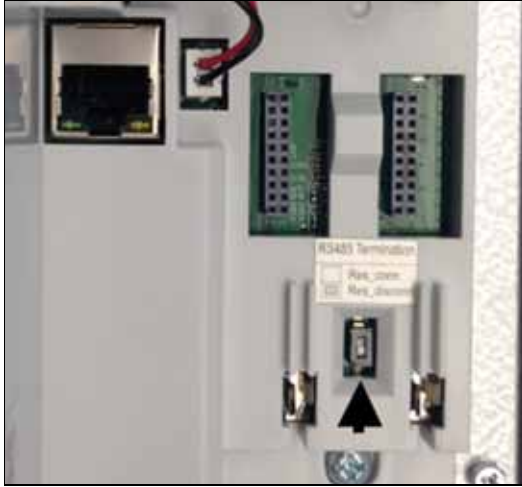
Şekil 33. RS-485 Bus Sonlandırma Kurulumu
