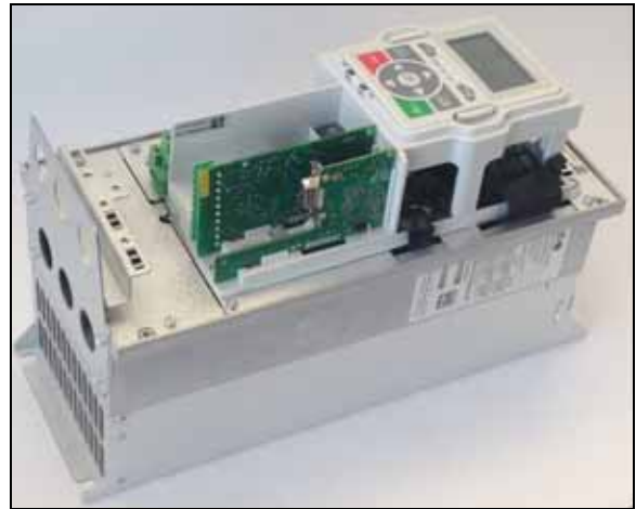
Figura 4. Schema della scheda di controllo del convertitore con slot di schede opzionali
