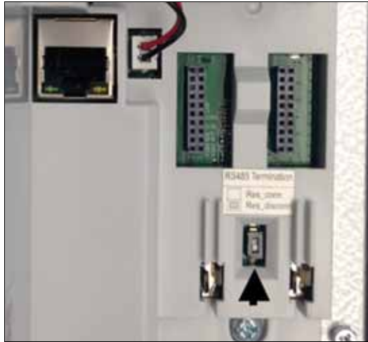
Figura 33. Configurazione terminazione bus RS-485
