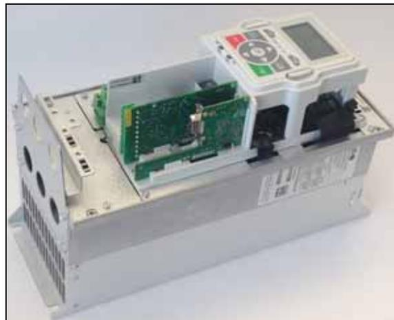
**Figure 4. Carte de contrôle du convertisseur de fréquence avec emplacements A et B pour cartes optionnelles**
