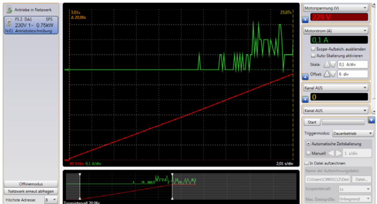
Abbildung 121: Nullpunktverschiebung des Stromsignals
