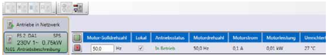
Abbildung 68: Der Frequenzumrichter ist in Betrieb (Die Motor-Solldrehzahl beträgt 50,0 Hz).
